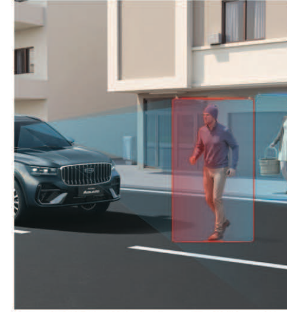
نظام الكبح التلقائي في حالات الطوارئ (AEB)
