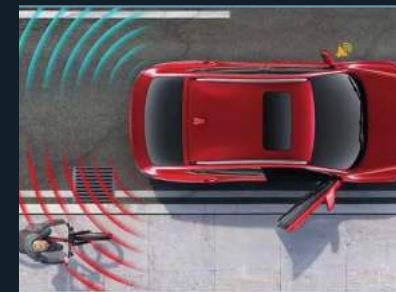
Door Open Warning (DOW)
